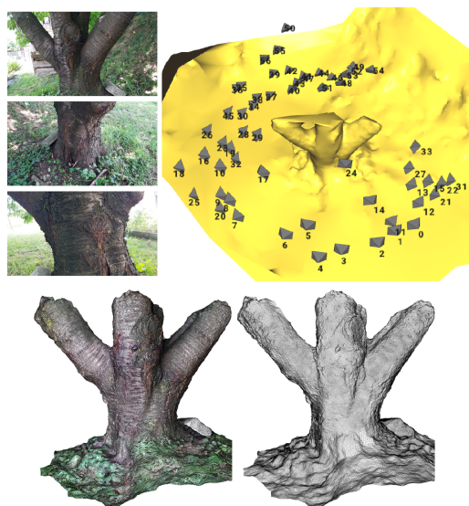
Slika 4: Nekaj primerov slik (levo zgoraj), postavitev kamer (desno zgoraj) in rezultat goste rekonstrukcije debla (spodaj).
