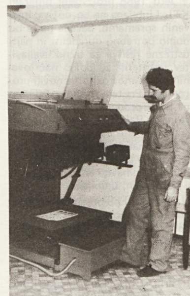
S kamero za preslikavanje se izdelava negativ tilm, ki je podlaga za izdelavo klišeja — flexo tiska.
