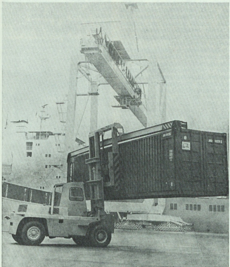
Naš 12,5-tonski viličar pri delu v koprski luki. Viličar ima napravo za prečni pomik in prijemalo za prazne kontejnerje. Prijemalo je izdelal Metil z Reke (Foto: J. Jereb)
