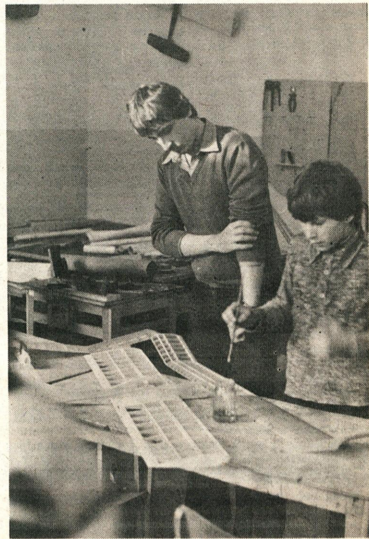
Letalski modeli se delijo v kategorije glede na težo, površino in način pogona. V skupino A-1 spadajo prostoleteči modeli za osnovna pionirska tekmovanja. F1-A so jadralice, F1-B so gumenjaki, F1-C so „penjači“, F2-A so akrobati, F2-B so brzinci, F2-C pa so modeli za ekipna tekmovanja. F3 so makete, F4 pa helikopterji. Daljinsko vodeni modeli pa imajo oznako RC. Mladi modelarji sčasoma spoznajo vse vrste modelov. (Foto: GO)
