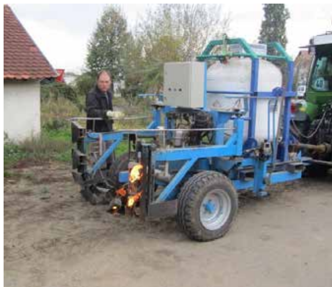
Stroj za uničevanje plevelov in odvečnih poganjkov hmelja (Foto: M. Rak Cizej)
