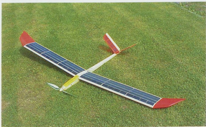
Model ima na krilu pritrjene štiri nize po 24 fotonapetostnih celic, namenjenih za pogon elektromotorja.
