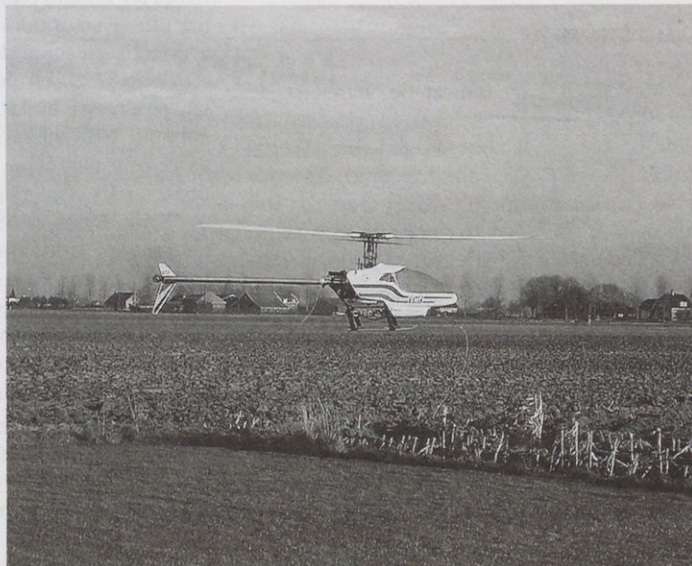
Med helikopterji serije ECO nemškega proizvajalca Ikarusa izstopa eco 8, ki je predviden za pogon z 6 do 12 celicami. Premer rotorja znaša 1060 mm. Z 10 celicami Sanyo RC2000 tehta model 1,5 kg in zmore 10 do 12 minut dolge polete.
