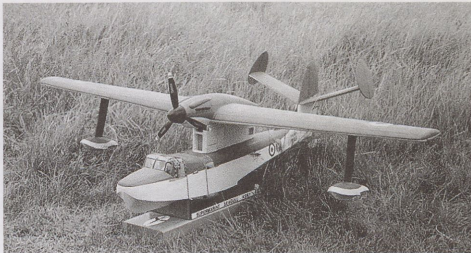
Električni pogon je zelo primeren za makete vodnih letal, saj tu ni bojazni pred nenadno odpovedjo motorja. Maketa Supermarine seagull ima razpetino krila 1,52 m, tehta 2,5 kg, poganja pa jo motor WEP turbo 10 plus z reduktorjem 3 : 1. Za napajanje služi 10 celic s kapaciteto 1700 mAh.
