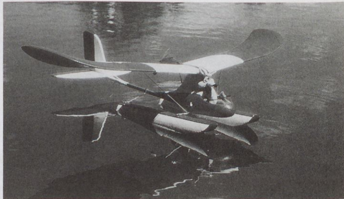
Wingo nemškega proizvajalca Kavan je v celoti izdelan iz stiropora v kalupu. Model ima razpetino krila 1 m, tehta 700 g, poganja pa ga motor Speed 400, ki se napaja iz 8 celic Sanyo s kapaciteto 500 mAh. Proizvajalec ponuja tudi dodatni komplet za izdelavo plovk, s katerimi wingo postane izvrsten vodni model.
