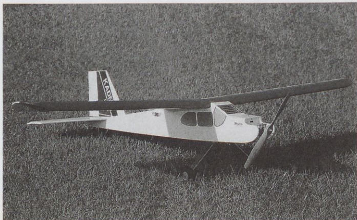
Tipični primer predelave modela, konstruiranega za motor z notranjim zgorevanjem. Trenažni model kadet LT-25 z razpetino krila 1,6 m in maso 2,7 kg poganja brezkrtačni motor MaxCim z reduktorjem 3 : 1, ki ga napaja 14 celic Sanyo 1700 SCRC.
