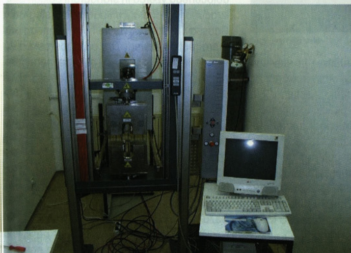
Slika 3 • Levo: naprava za testiranje materialov Zwick/Roell tip TC-FR010TH.A50 in desno: temperaturna komora na Fakulteti za gradbeništvo Univerze v Mariboru
