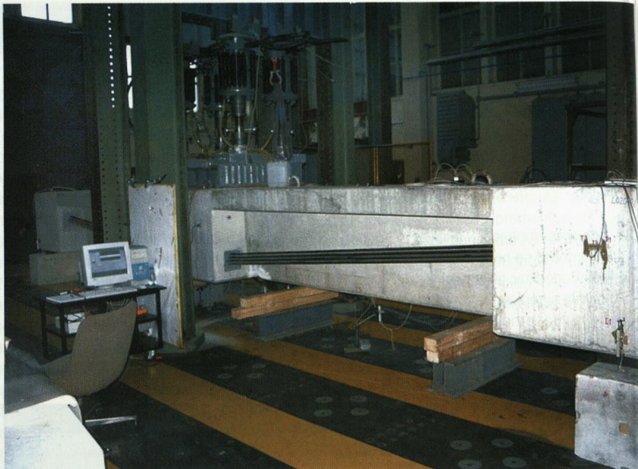
Slika 5 • Preskuševališče za upogib prednapetega nosilca
