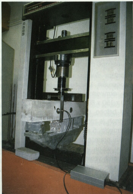
Slika 4 • Natezno upogibni stroj Instron 1195 med upogibnim preskusom betonske prizme
