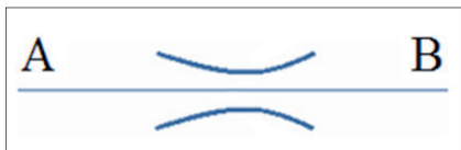
Slika 4. Hidravlični simbol fiksne dušilke (konstanten premer)
