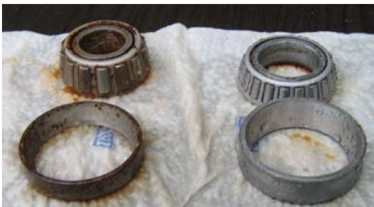
Izgled ležajev, če niso oz. če so zaščiteni z zaščitnim nanopremazom
