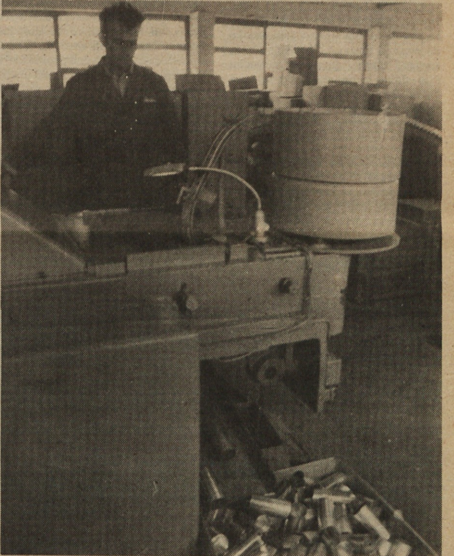
Mogočna stiskalnica, ki odtisne do 4.000 lončkov za kondenzatorje v eni uri. V novem obratu v Semiču (preurejenem) je pred mesecem stekla poskusna proizvodnja. Več o tem prihodnjič.
