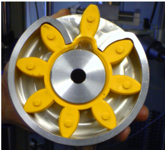
Fig. 9. Insert pulling rig
