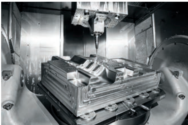
» Slika 3: Petosna obdelava velike in težke orodne plošče za veliko orodje.
