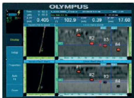
» Slika 2: C-scan na zaslonu pri vrtničnih tokovih
