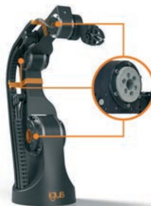
» Slika 9: Trije velikostni razredi simetričnih členov (dvojni ležaj) z direktnim pogonom (robolink®-D)
