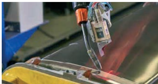
» CST Flex D – laserski senzor izvaja popravke med varjenjem in s tem zagotavlja optimalne rezultate varjenja.
