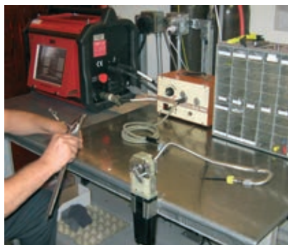
» Slika 10: Varjenje manjših cevovodov [9]
