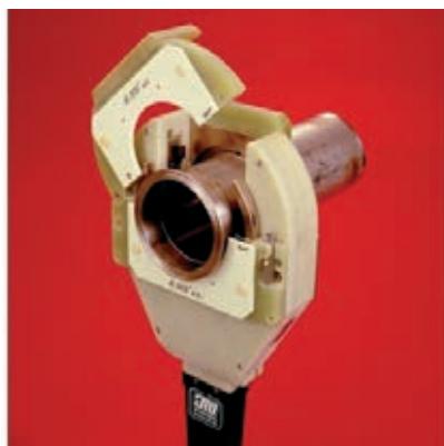
» Slika 9: Zaprti tip varilne glave za orbitalno varjenje. Glava z cevjo mirujeta, elektroda pa se v notranjosti premika in izdela zvar [8]
