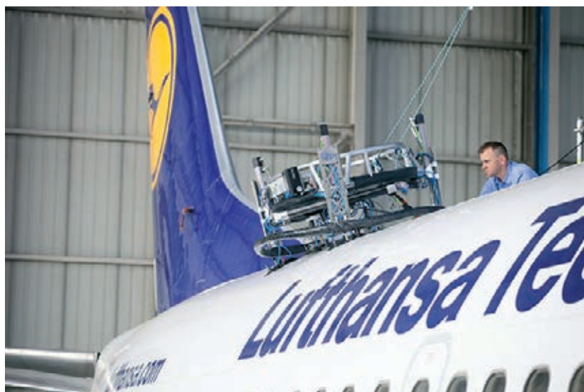
» Slika: MORFI robot za inšpekcijski pregled napak (razpok) na letalih.
