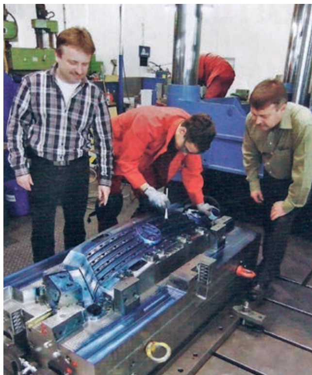
» Rezanje do popolnih dimenzij predvsem pri velikih kalupih ni možno. Preizkusni stroj zagotovi točnost do zadnjih stotink.
