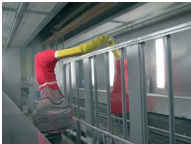
» Slika 7: Lakirna robota barvata osnovo bivalne enote
