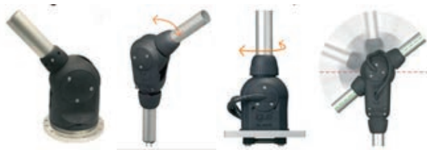
» Slika 3: Razpoložljivi členi žičnega robotskega modularnega sistema robolink®-W: a) osnovni, b) nihajni, c) vrtljivi, d) dvoosni
