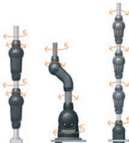
» Slika 3: Razpoložljivi členi žičnega robotskega modularnega sistema robolink®-W: a) osnovni, b) nihajni, c) vrtljivi, d) dvoosni
