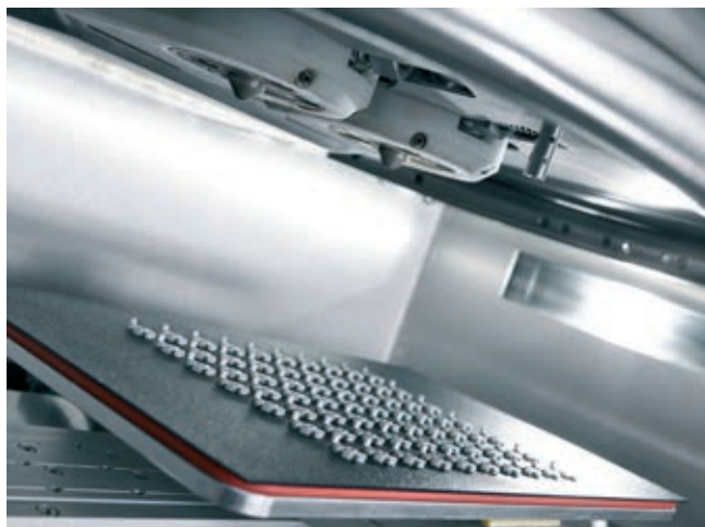
» Slika 1: Freeformer potrebuje za izdelavo male serije 70 distančnikov iz visokotemperaturnega termoplasta PEI okoli 3 ure
