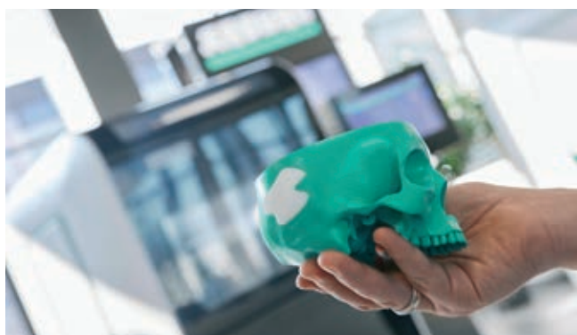
» Slika 4: Kot primer je Freeformer izdelal individualno prilagojen implantat za lobanjsko kost iz granulata medicinskega PLA
