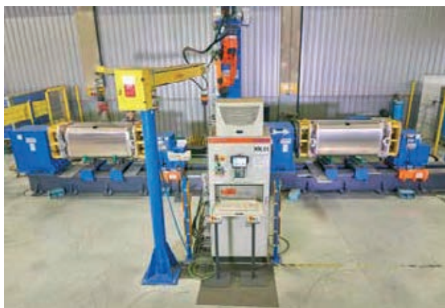
» Robotska naprava je sestavljena iz dveh postaj, kjer so aluminijasti rezervoarji pripravijo za vpenjanje in zvarijo.
