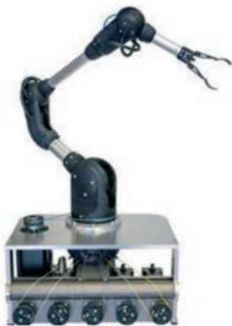
» Slika 6: Primer šestosne robotske roke z žičnimi vrvicami robolink®-W
