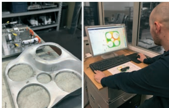
» Inšpekcijsko poročilo, ki kaže odstopanje od CAD-podatkov, ki izhajajo iz celovitega merjenja.
