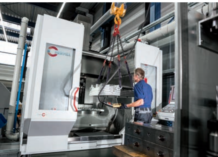
» Slika 2: Preprosto nakladanje obdelovanca na obdelovalni center C 60 U z uporabo žerjava in dvojno odprtimi vrati.
