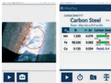
» Slika 7: Slika zvara in kemična sestava materiala/zvara
