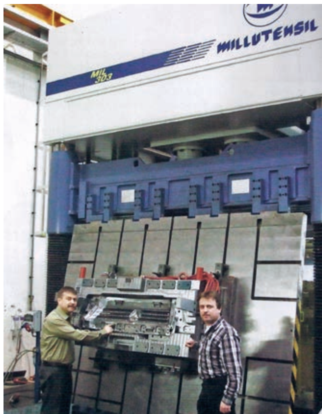
» Štanca se zavrti do 180 stopinj in s tem omogoča nastavitve najustrežnejšega položaja.
