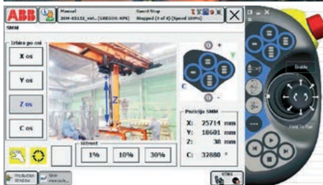
» Slika 6: Vmesnik za ročno pomikanje strežnega portalnega manipulatorja.
