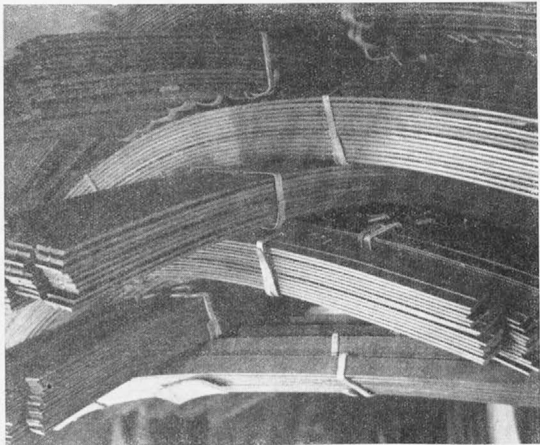
Znan izdelek naše železarne so tud i listnate vzmeti za avtomobile itd.
