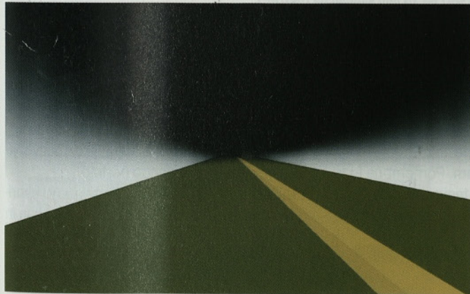
Slika 8 • Vidljivost v predoru na višini 1 meter in oddaljenosti 50 m od požara po 900 sekundah simulacije gorenja avtomobila
