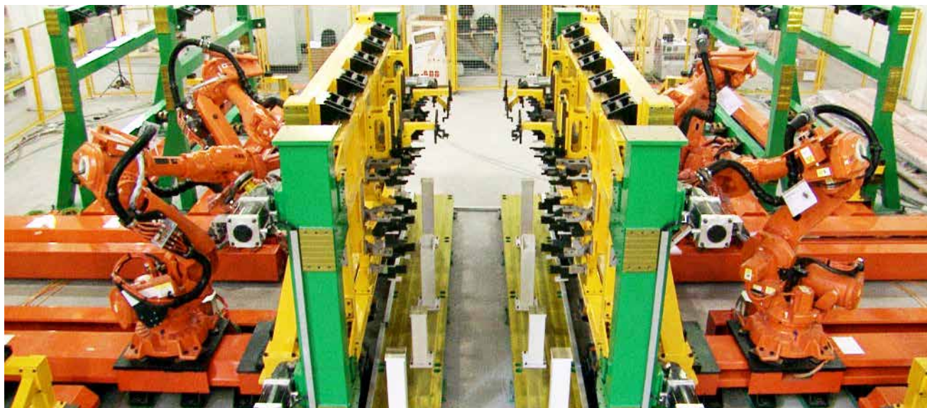
» Na isti liniji se lahko proizvaja do šest izvedenk karoserij, z menjavo sten, ki nosijo orodje za posamezen model.
