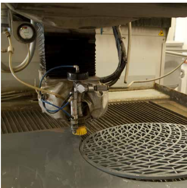
› Ko je del dokončno oblikovan, ga izrežejo iz dražjega materiala, kot je npr. granit, nerjavno jeklo ali titan.
