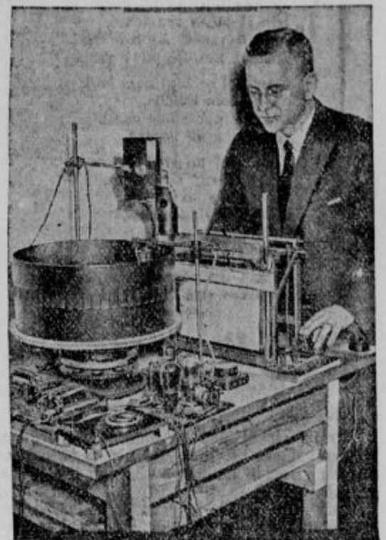
Jurij Sutkowski je sestavljal aparat, s pomočjo katerega je mogoče tiskano besedo izpremeniti v glas, in sicer po zakonu o optični kongruenci. Iznajdba je velike važnosti za slepce, katerim bo na ta način mogoče brati knjige. Aparat bo mogoče uporabljati samo za fonetično pisavo, ki bo točno označila ton besede
