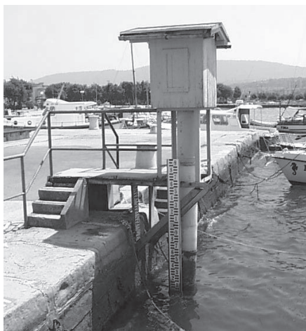
Slika 1: Stari mareograf iz leta 1958 (levo) in novi mareograf s permanentno postajo GPS (desno).
