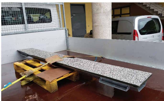
Slika 16. Vzorčni primer pohodne podnice s polnitvijo iz lomljenega granita in EPDM-gume.
