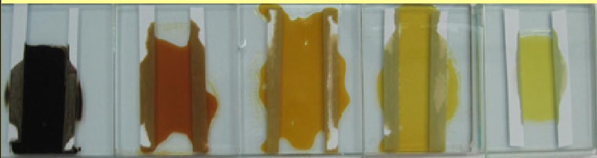
Spremembe barve utekočinjenega lesa zaradi razbarvanja z vodikovim peroksidom, aktiviranim s sistemom manganov sulfat / natrijev bikarbonat.
