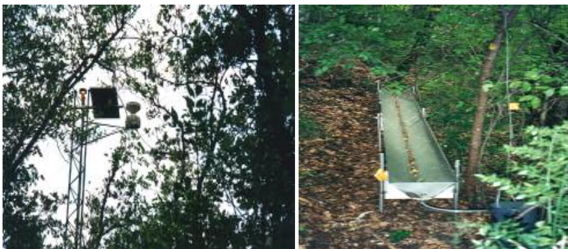
Slika 3 – Meritve količine padavin nad krošnjami (levo) in meritev količine padavin, ki padejo skozi krošnje dreves (desno).
