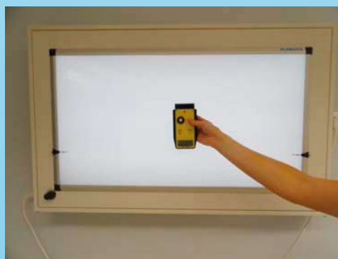
Slika 2: Primer merjenja svetilnosti negatoskopa.
