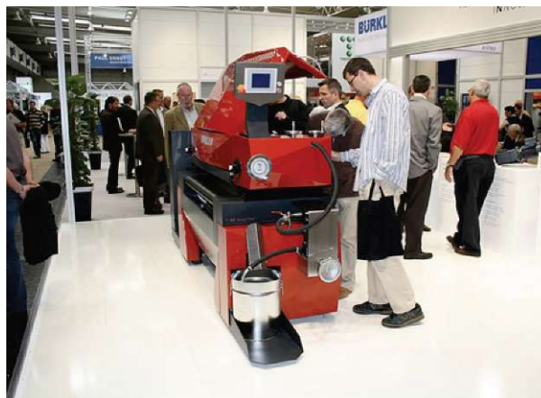
Slika 4. Bürkle lakirna linija za valjni nanos osnovnega in končnega premaza za ploske obdelovance (www.buerkle-gmbh.de)
