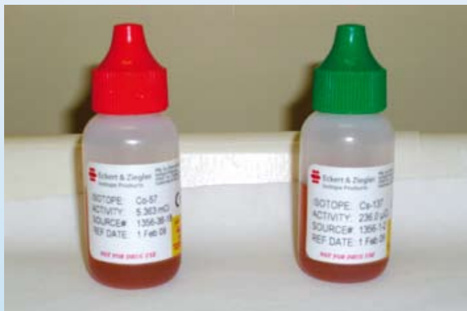
Slika 1: Certificirana zaprta vira sevanja ^{57}\text{Co} in ^{137}\text{Cs} , uporabljena pri testu točnosti in stabilnosti
