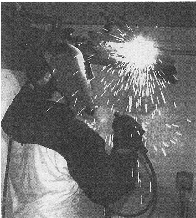
Slika 2: Varilec mora med varjenjem zelo natančno voditi varilno pištolo v različnih in spremenljivih položajih
