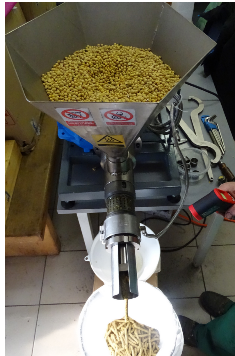
Merjenje delovne temperature stiskalnice med stiskanjem soje na stiskalnici AIS P 60 (fotografija: T. Poje)
