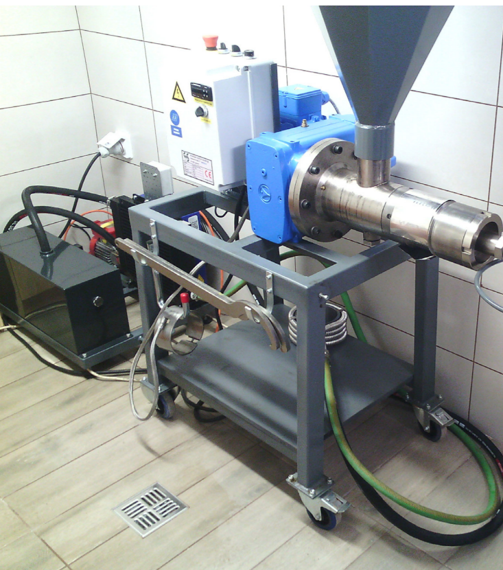
Vijačna stiskalnica AIS P 95, moči 4 kW omogoča večji delovni učinek pri stiskanju soje, primer mikro oljarne na kmetiji (fotografija: V. Jejič)
