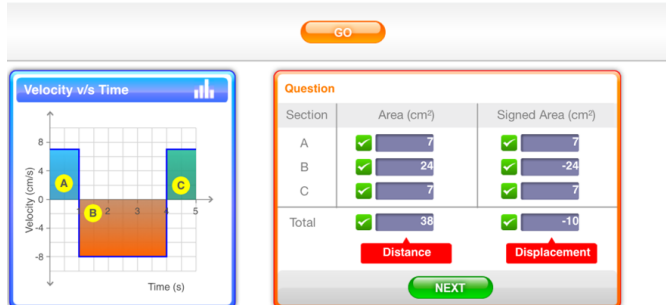
Slika 6. Na odseku B se voziček pelje v levo, kar pomeni, da se odmik (po ang. displacement) od prvotne točke zmanjšuje.
