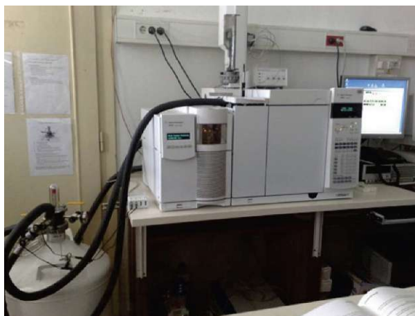
Slika 3: Plinski kromatograf agilent technologies 7890 (agilent, ZDA), sklopljen s kvadrupolnim masnim spektrometrom agilent technologies 5975C ^agilent, ZDA)
