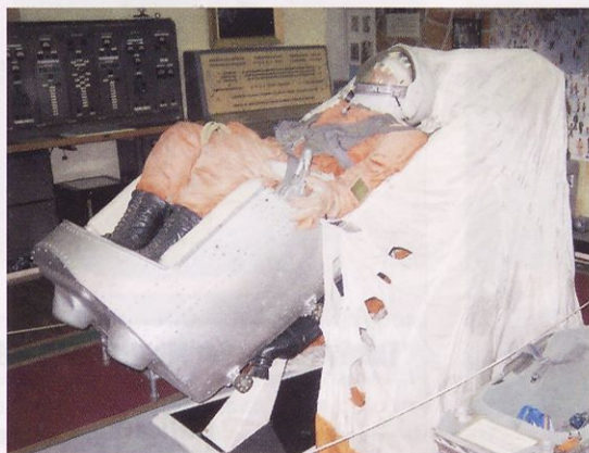
Katapultni sedež, s kakršnim so se Gagarin in vsi ostali kozmonavti programa Vostok med pristajanjem izstrelili iz vesoljske ladje, razstavljen v muzeju na kozmodromu Bajkonur. (Foto: Jože Čuden)
