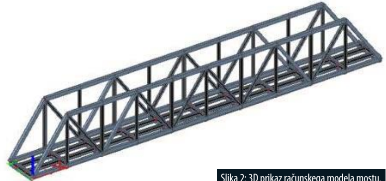
Slika 2: 3D prikaz računskega modela mostu.
