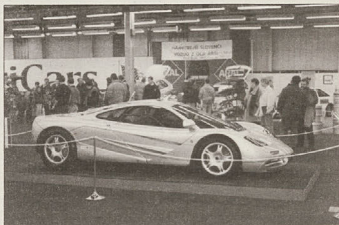
McLaren F1 s 5700 kubičnim V12 motorjem, ki razvije 600KM pri 7800 vrtljajih na minuto, požene to, kar bi le stežka še imenovali avtomobil, v prvih 3.8 sekunde do 100 kilometrov na uro in nekaj kasneje do 370 kilometrov na uro.
