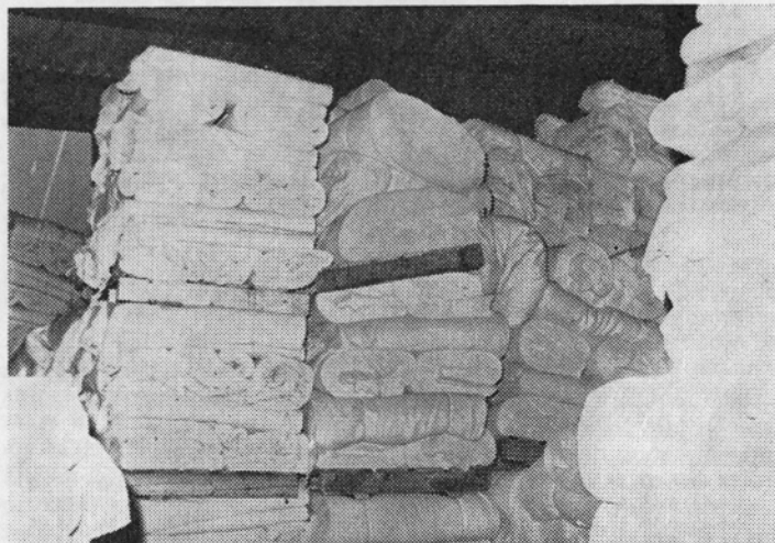
V TOZD Oplemenitilnica že dalj časa opozarjajo na kopičenje zalog surovih tkanin ter neprimerno skladiščenje le-teh. Komadi blaga na paletah so naloženi eden na drugega tudi do 5 metrov visoko, kar predstavlja življenjsko nevarnost za delavce, ki so zaposleni v skladišču.
