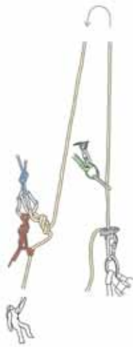
Slika 2c: Izdelava dodatnega varovanja ("back-up")
