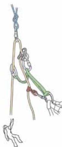
Slika 2e: Simultani spust – situacija pred spustom
