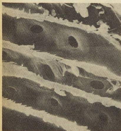
Dvostolpne cevčice borovega lesa, 1500 kratna povečava.
