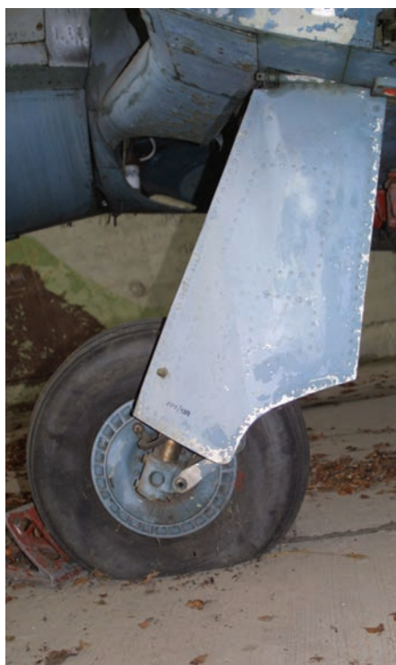
Pogled na sprednje noge podvozja nam prav tako razkriva dve različni modri barvi na spodnjih površinah letala. Na spodnjem robu kolesnih pokrovov je zapisana številka XVII/129, katere pomen še ni znan. (Foto: Tomaž Perme)
