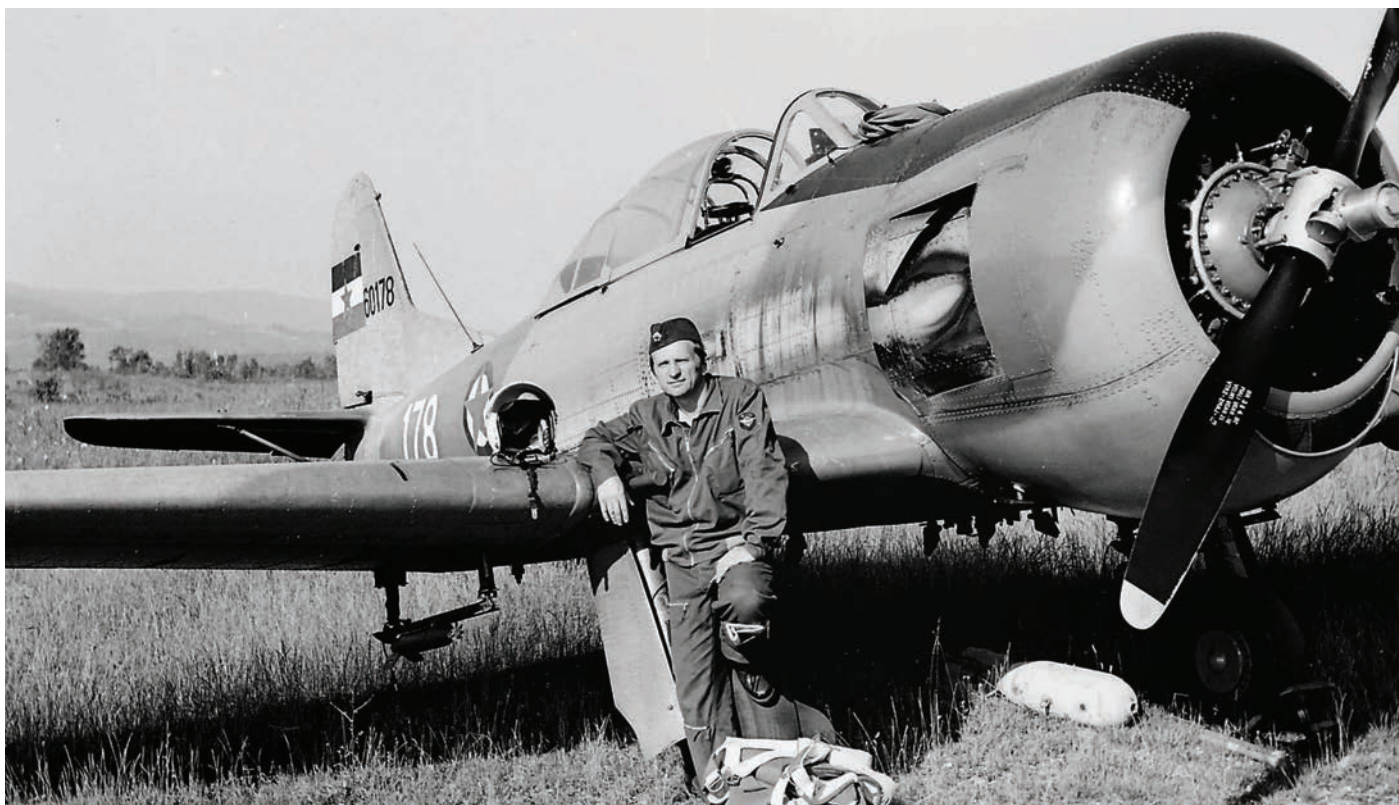
Letalo soko 522 s serijsko številko 60178 na letališču Cerklje ob Krki, kamor se je enota TE preselila v času urjenja v uporabi bojnih sredstev na poligonu Paka. Letala soko 522 Trenažne enote so imela znak le na levi strani. Na desnem boku so vidne sledi saj izpuhov motorja. Pod letalom je videti cementno avio bombo, pod krilom pa obešeno šolsko raketo. Pilot Janez Oblak, ki stoji pred letalom, je oblečen v temno moder letalski kombinezon, ob sebi pa ima letalsko čelado PK-07, ki so jo po ameriški licenci izdelovali v ljubljanskem Libisu. Pred nogami ima prislonjeno reševalno padalo, ki ga je pilot ob vstopu v letalo namestil na dno sedeža.
