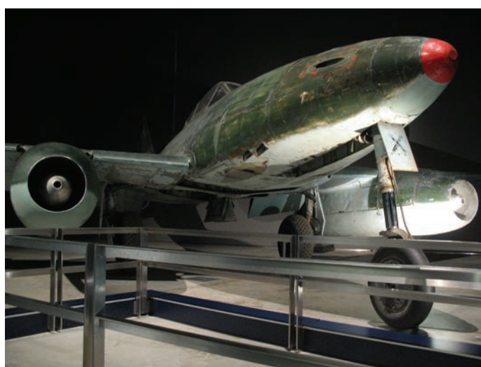
Me-262A-2a s serijsko številko 500200 v Australian War Memorial Museum v Canberru je prav tako edino letalo tega tipa, ki je ohranjeno v izvirni podobi. Na letalu se vidijo obrabljena mesta, ki so nastala med uporabo v vojnem času. Na nosu je opazna izbrisana številka 200 in sledovi plasti različnih barvnih opleskov. (Foto: Universal Nation, Wikipedia)
