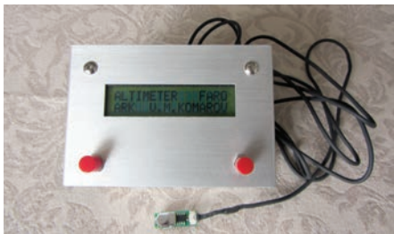
Podporna naprava med štartom meritev modelarskega višinomera oziroma odčitavanjem dosežene višine
