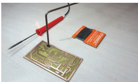
Garažni pripomoček pri spajkanju komponent za površinsko montažo (glej besedilo)
