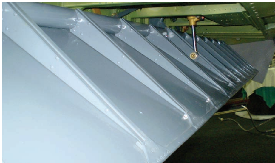
Zakrilca na spodnji strani krila letala soko 522 segajo čez celotno širino centropлана in se enostavno spuščajo in dvigajo na eni osi. Fotografijo je posredoval Živko Gospić
