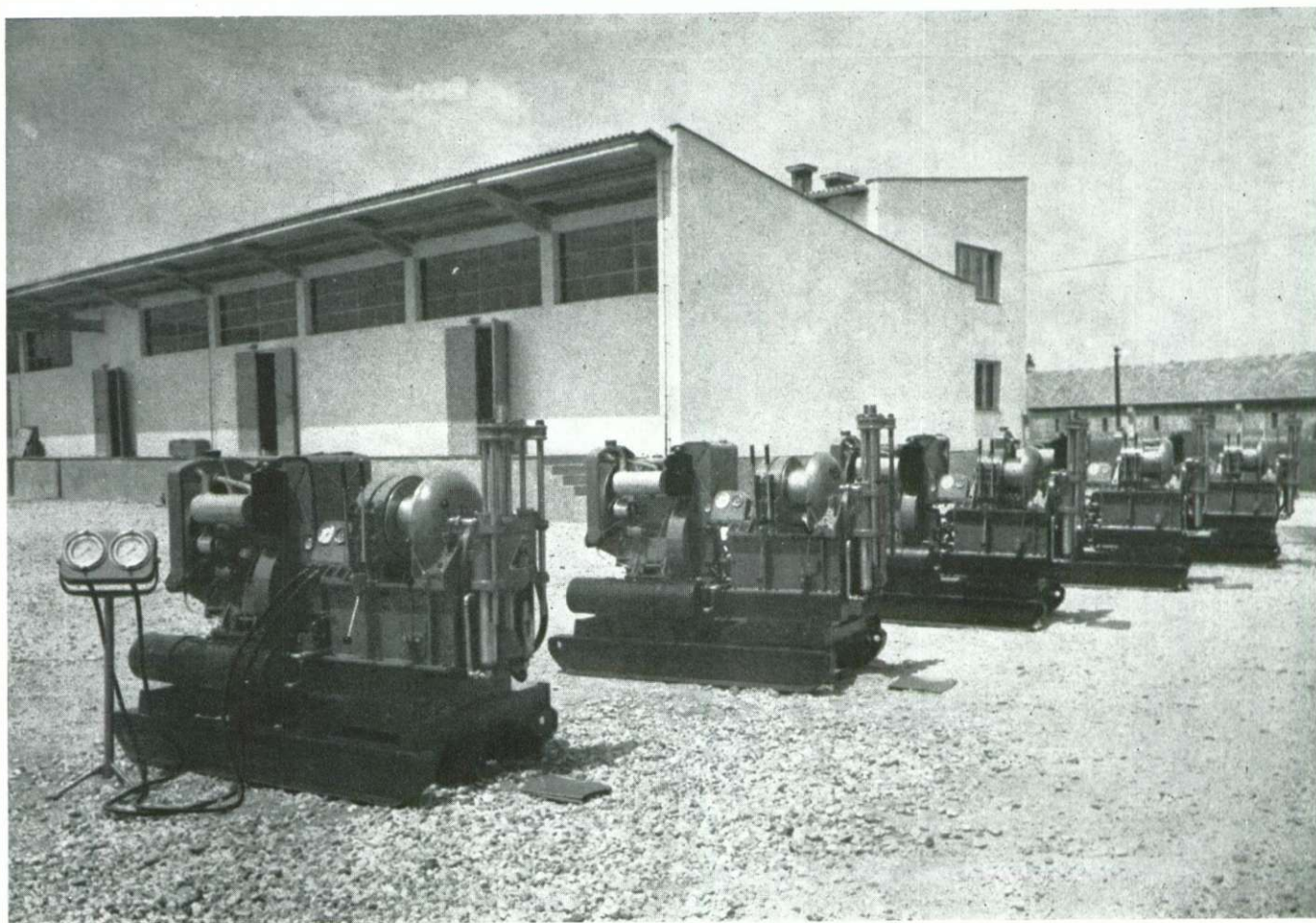
4. sl. V novi delavnici Geološkega zavoda so izdelali prvo serijo vrtnih strojev »J 600«
