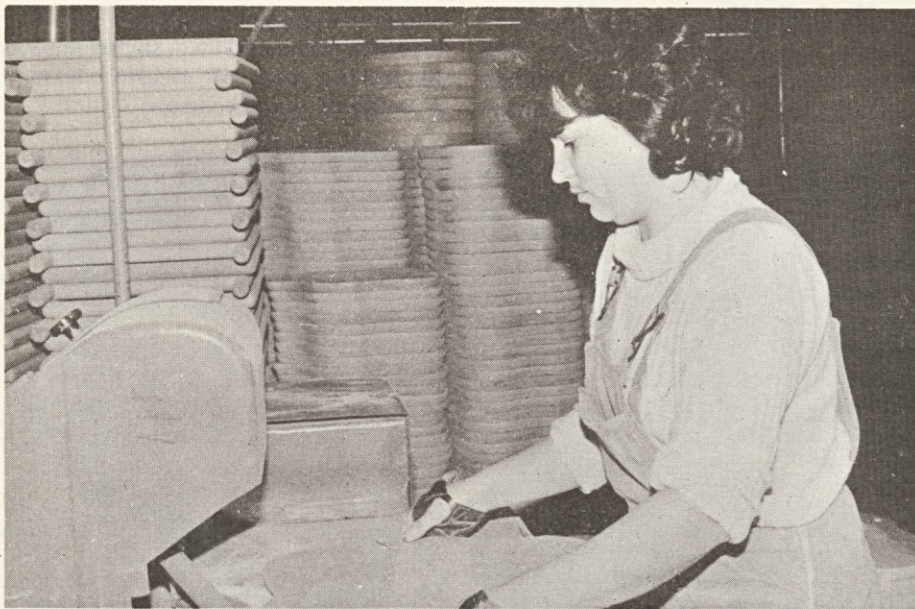
Prostoročno brušenje oboda masivnega sedeža je bilo zelo težko delo in so ga zmogli le moški. Brušenje na ustreznem stroju je tudi hitrejše, boljša je kvaliteta.
