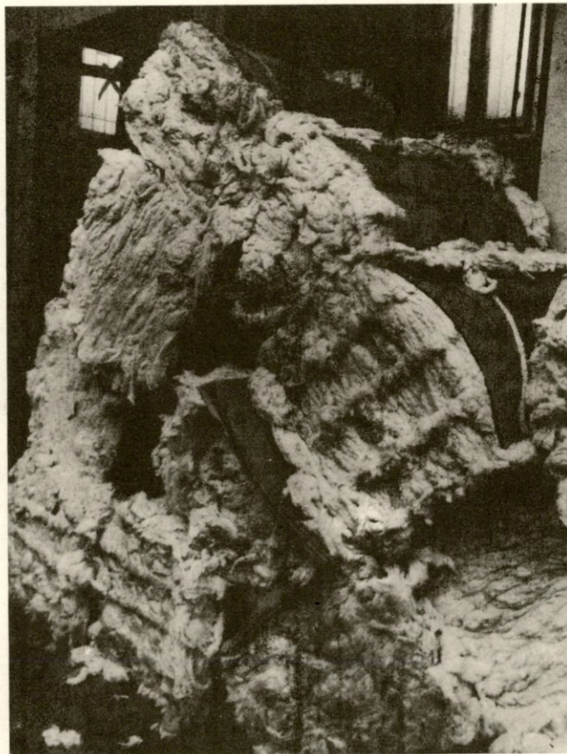
Tekstilni bombažni odpadki iz katerih Zdenko in Mladen s pomočjo Temafo linije izdelujeta povsem čisto in snažno belo bombaževino
