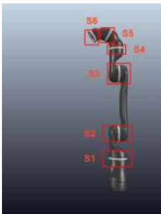
Slika 4: Robotska roka Kinova Mico z označenimi sklepi S1-S6
