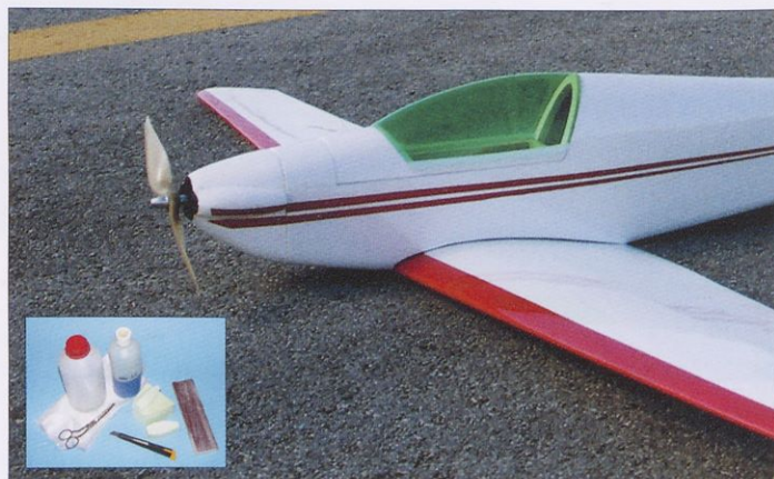
Pozitivni pramodnel iz stirodura s pomočjo risb oblikujemo postopoma po ravninah. Za laminat zadostujejo tri plasti steklene tkanine 50 g/m 2 , prepojene s kakovostno, 24-urno epoksidno smolo.
