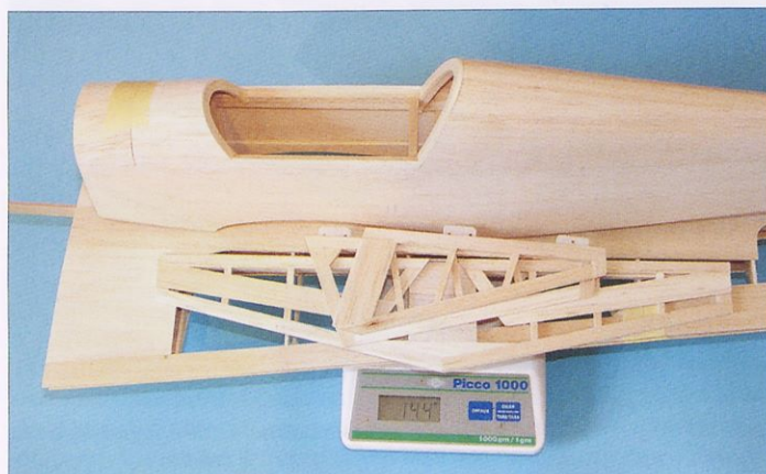
Na prekrivanje pripravljen model tehta dobrih 140 g, k čemur je treba dodati še maso folije za prekrivanje, zasteklitve kabine in pokrova motorja. Prekrit model brez RV-opreme tehta 220 g.
