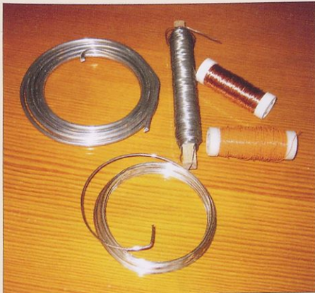
Slika 1. Raznovrstna žica za izdelavo nakita: aluminijasta, bakrena, barvno oplasčena
