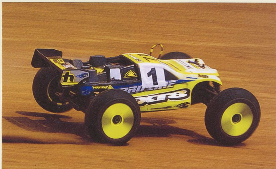
Modeli truggy v merilu 1 : 8 imajo večja kolesa, daljše medosne razdalje in močnejše motorje. Na razgibanih terenih so skoraj enako hitri kot modeli buggy.
