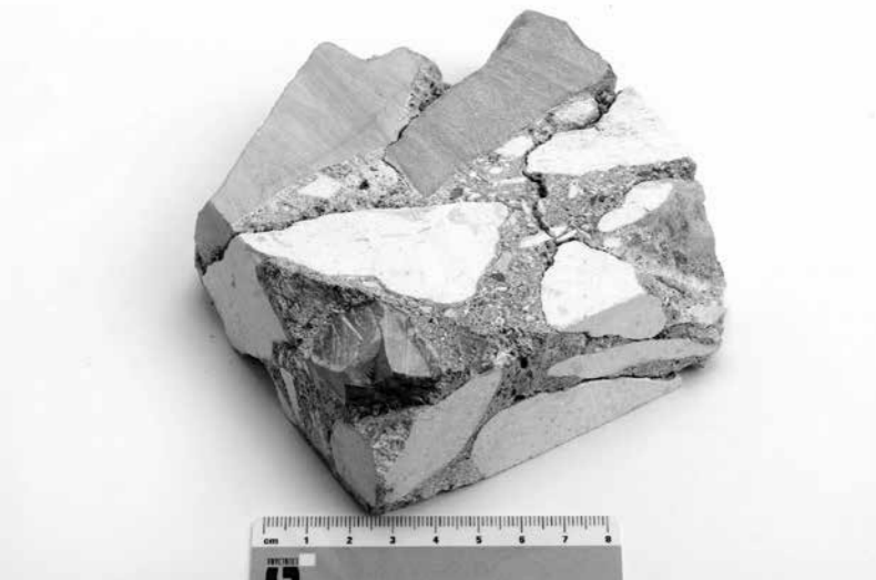
Slika 1: Beton iz Dioklecijanove palače. Figura 1: Calcestruzzo dal Palazzo di Diocleziano.
