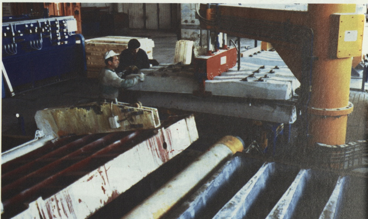
Slika 4: Spredaj razopaženje, zadaj roka za prenos izdelanih pragov na odpremno linijo
