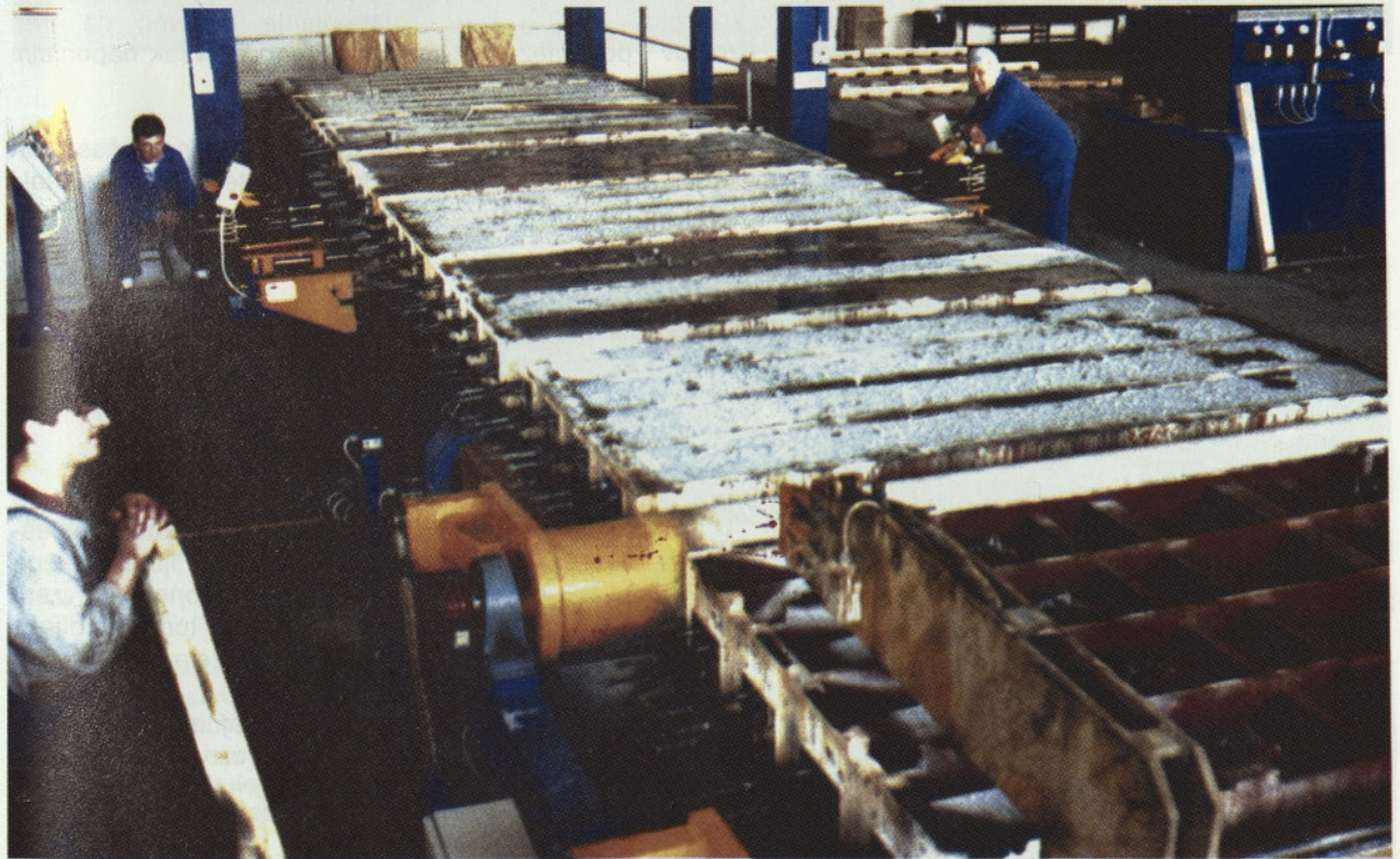
Slika 3: Zadaj popuščanje (= odvijanje napenjalnih vijakov), spredaj razopaženje pragov
