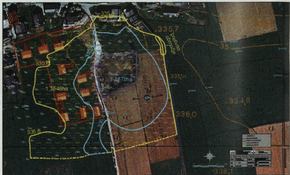
Slika 7 • Poplavno območje zazidalnega načrta Zapogge 1 pri kotah 335,8 m in 335,4 m
