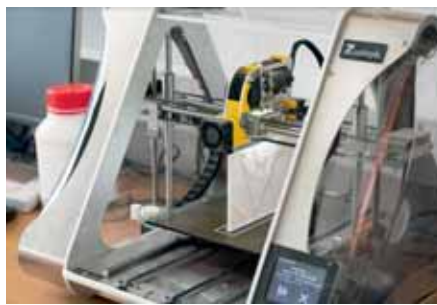
Slika 5: Kopiranje detajlov s 3D-tehnologijami (zajem s skenerjem, 3D-tisk, UV-kapljični tisk fotografije slike na predhodno 3D-tiskan reliefni detajl)
