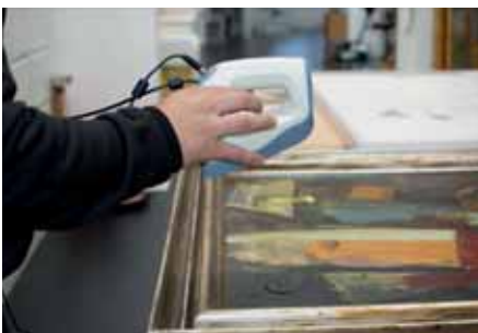
Slika 5: Kopiranje detajlov s 3D-tehnologijami (zajem s skenerjem, 3D-tisk, UV-kapljični tisk fotografije slike na predhodno 3D-tiskan reliefni detajl)
