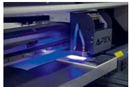
Slika 5: Kopiranje detajlov s 3D-tehnologijami (zajem s skenerjem, 3D-tisk, UV-kapljični tisk fotografije slike na predhodno 3D-tiskan reliefni detajl)
