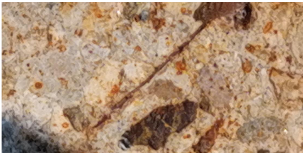
Slika 12: Jekleno vlakno z dolžino 30 mm in premerom 0,5 mm na površini praga.
