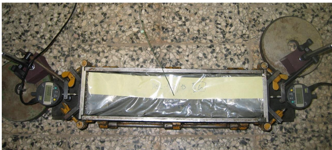
Slika 5: Spremljanje deformiranja betona v zgodnjem obdobju.
