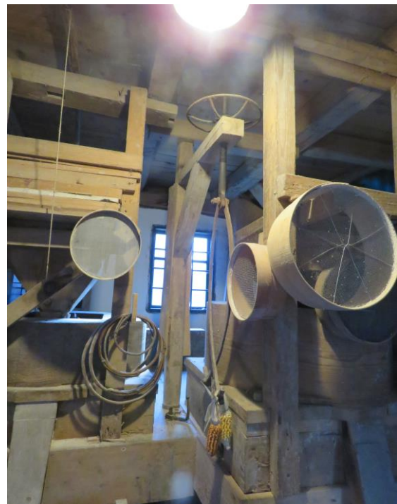
Slika 66: Mlevska sita in v sredini pripomoček za dvigovanje mlinskega kamna. Selankin maln .
