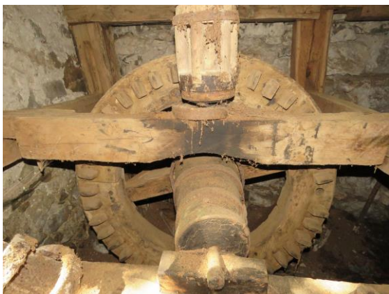
Slika 39: Prenos vrtenja horizontalne osi se vrši preko kolesa s pauci – gre za lesen zobniški prenos, ki poveča hitrost vrtenja kamnov.
