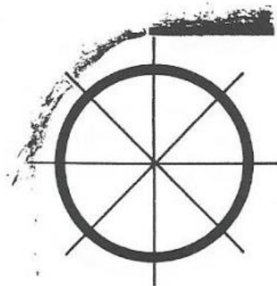
Slika 37: Mlinsko kolo s horizontalno osjo, na nadliv.
