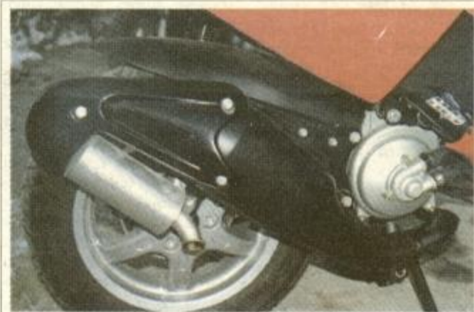
Benelli 491 racing je serijsko opremljen z resonanco Arrow.
