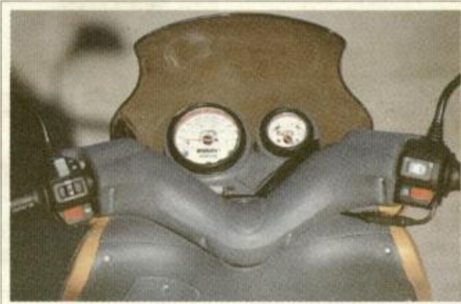
Betini merilniki niso nameščeni na krmilu, ampak na konzoli izza vetrnega ščitnika.
