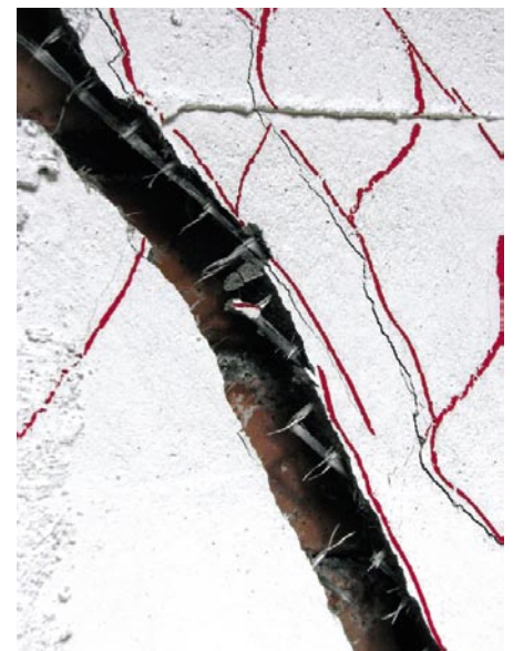
Slika 18 • Detajl pretrganja niti diagonalno položene GFRP-mreže (utrditev tipa 7)
