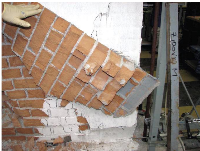
Slika 19 • Detajl odlučene obloge z GFRP-kanino v epoksidni matriki po končani preiskavi (utrđitev tipa 9)
