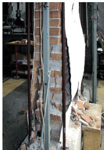
Slika 20 • Izbočenje obloge z GFRP-kanino v epoksidni matriki (utrđitev tipa 9)
