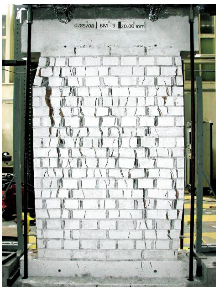
Slika 11 • Referenčni, neutrjeni zid pred porušitvijo
