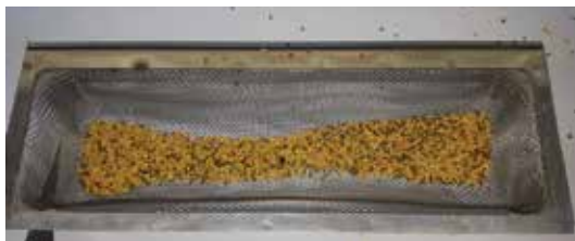
Predalček prototipa je izdelan iz nerjaveče mreže.
