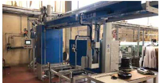
Proizvodna linija za avtomatsko brizganje fluoriranih termoplastov. (Foto: Luka Fideršek)
