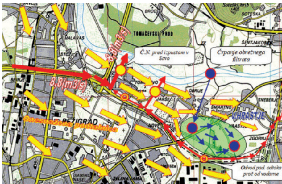
Slika 8 • Predlog aktivne zaščite podtalnice pri črpališču Hrastje
